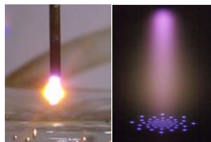
図 4. 水面に形成される大気圧グロー放電と発光の自己組織化
